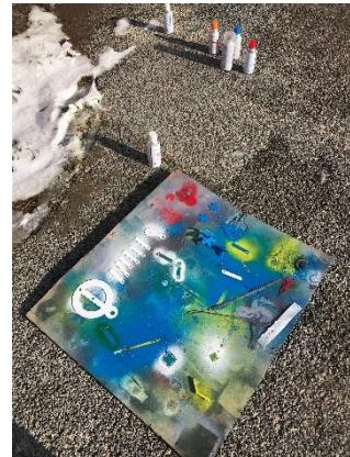
结果组装时又发现喷漆带来了一些问题。首先是台虎钳夹持的时候把漆弄脏了，只好最后再去补一下漆；其次是喷了漆之后，发现转动阻力变得非常大，显然是由于漆与漆之间的摩擦远大于金属之间摩擦。没有太好的办法，只能用力多转转手里剑和指针，让中间接触部分的漆被刮掉或磨掉一些。
