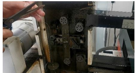
星星外形切到一半，我看着却觉得越来越不对。已经切出的轮廓中，之前打的孔完全不在预定位置上，甚至差一点就要被切掉。切完后一看，没有一个孔在预想的位置上。难道是我图纸上测量孔的位置量错了？还是划线时划错了？每个数字我都校对过好几次，就算错也不应该全错。难道是上下反了？我把图纸旋转了 180 度，却发现这是个完全对称的图形。思索良久，突然意识到，会不会是划线打孔是一面，拿去线切割时是另一面？这样，相当于六
