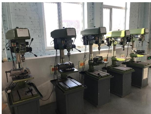
柄，在钻头下钻的同时喷冷却液。下钻时会产生小碎屑和长长的卷曲的大铁屑，如果干扰到加工就得先把钻头退出来，甚至要先关掉后拿掉绕在钻头上的铁屑重新开启。在钻的同时还要注意一下进度，凭感觉或是看刻度线，到了快钻透的时候，放慢速度。当钻头突破了最后一层，不再发出切削的噪声，右手上的阻力一松，整个人都舒服了。当然，还要小心翼翼地将钻头退出来。
