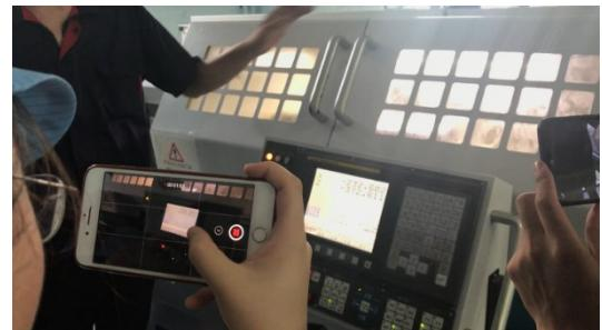
亲自车了一根轴示范了全流程。流程大体分为三步，把铝棒装夹上后，首先利用目测对齐，并径向、轴向分别车一刀，把车床数控系统的坐标定位到铝棒上，顺便使其表面平整。例如，在移动刀具的时候目测刀具快要从径向碰到轴，就关上车床门，设置此时轴向坐标为零，让主轴带着工件开始旋转，启动冷却液，缓慢手摇控制刀头沿径向向内。在接触到工件时，如果一切正确，会听到悦耳的切削声。沿径向切到里面然后再退出来，停下旋转和冷却液，打开车门一看就得到了泛着径向放射的金属光泽条纹的圆面。此时，轴向坐标零点就确定在这个面上了。换一个方向同理确定径向零点，但是最后要拿游标卡尺卡一下轴的直径，然后将其输入系统作为径向坐标。
