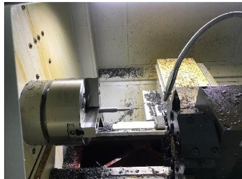
在加工的时候还发生了一些有趣的事。不知是哪个同学车的时候，大家围在旁边看，正打开车床门瞧着刀具位置的时候，有一个同学没注意地上的装夹开关，踩到了脚踏板，结果轴就晃动了——于是之前设的坐标零点就全乱了，得重来一遍。
