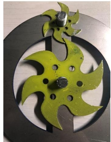
首先大齿轮带小齿轮转，大齿轮转一圈小齿轮也转一圈，所以平均角速度其实一样，这和传统齿轮传递线速度不同。然后，大齿轮在转动时，每 60 度中只有 30 度把小齿轮推动了 60 度，另外 30 度在空转。就是说，大齿轮匀速转时小齿轮会转一下停一下。而小齿轮带大齿轮转，则会一直空转。另外，小齿轮处于特定位置时会出现死点，即大齿轮和小齿轮会卡死无法转动。在正转时很少会出现死点，倒转时转一两圈就会出现。
